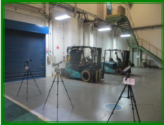
ภาพถ่ายการตรวจวัดระดับเสียงในสถานที่ทำงาน บริเวณ Battery Charger Room
